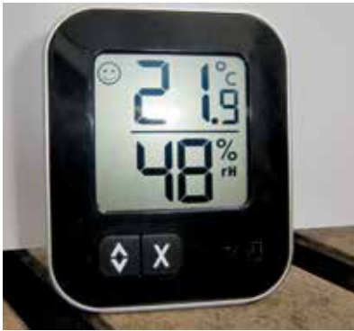
Ein Thermo-Hygrometer zeigt die Raumtemperatur und die relative Luftfeuchte an.
